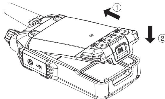
Для снятия аккумулятора оттяните на защелку фиксатора, потяните вниз и снимите аккумулятор.
