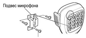
Винт для крепления подвеса микрофона (3 х 10 мм)
