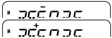
Если сдвиг частоты передачи выходит за пределы рабочего диапазона радиостанции, передача невозможна. В этом случае настройте частоту приема таким образом, чтобы частота передачи находилась в допустимых пределах, или измените направление частотного сдвига.
