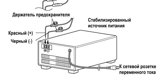
2 Подключите разъем питания постоянного тока радиостанции к разъему на кабеле питания постоянного тока
